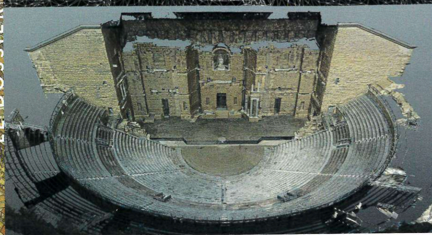
Extrait d'un assemblage de nuages de points du théâtre avec la colorisation des points à partir des photos. © M. Panneau, IRAA / A-BIME
